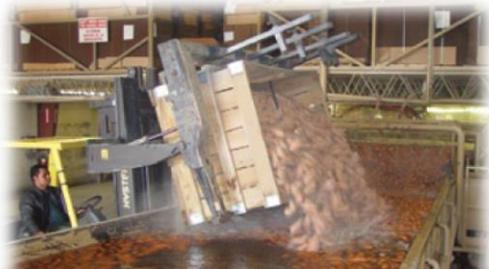
*Versement des racines tubéreuses de patate douce dans l'eau à l'aide d'un chariot élévateur*
