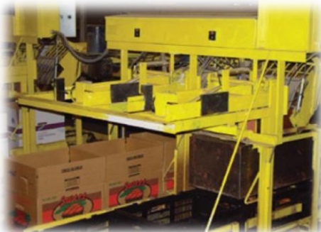
Vifaa vya kujazia vya automatiki vilivyounganishwa kwenye kifaa cha elektroniki cha kupanga bidhaa kulingana na ukubwa
