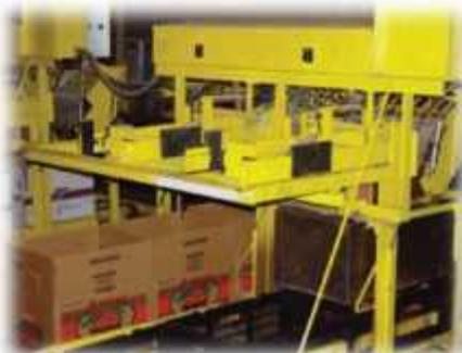
*Empacotadores automáticos integrados em equipamento de selecção electrónica*
