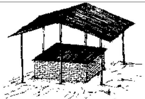
8. Construa um telhado de palha sobre a câmara para a proteger de luz solar directa e da chuva
