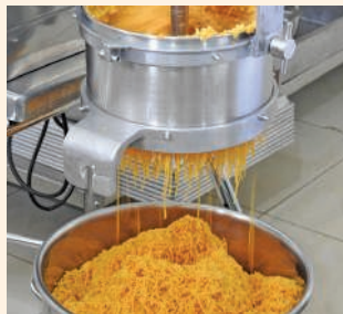
Production de purée de PDCO à partir de racines passées à la vapeur et pelées
